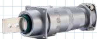
RM型コネクタは、定格電流500Aの大電流単極コネクタです。プラグが圧縮接続、レセプタクルが端子接続となっています。
