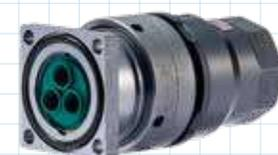
VA型コネクタは、ZBC型コネクタの防水性能及び施工性・操作性をより高性能にしたコネクタです。メタルタッチ構造を採用することにより、ねじの締付けの安定と締付トルク管理が不要のコネクタです。
