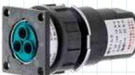
ZBC型コネクタは、火力発電所向けのコネクタです。平面Oリング方式のシール構造で、接続ナットをトルク管理で締付けることで防水性と強度を維持しています。全国の発電所で多数採用されています。ZBCA型はZBC型の一部の材質を変更した地熱発電所向けコネクタになります。
