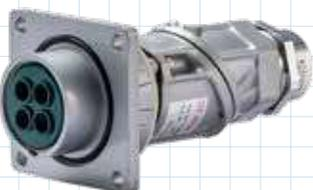
BC II B型コネクタは、火力発電所向け大型コネクタです。平面Oリング方式のシール構造で、接続ナットをトルク管理で締付けることで防水性と強度を維持しています。全国の発電所で多数採用されています。
