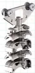
ケーブルクランプと走行用ローラ付のキャリア本体（ランナ板）の連結部が自在に回転します。キャリア収納の際には、このクランプ部がケーブルの動きに応じて回転し、狭小なスペースへより円滑にケーブル（キャリア）を収めることができます。また、クランプにはケーブルに沿ったR形状を施すなど、ケーブルを傷つけることのないよう考慮しています。
